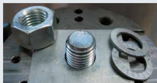
После демонтажа отпечаток зубчатых насечек должен быть виден как на крепежном элементе, так и на сопрягаемой поверхности.
