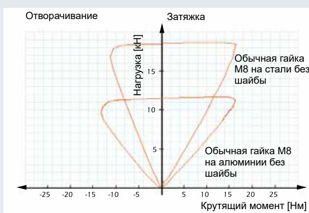
Если под крепежным элементом не используется шайба, сила трения зависит от контактной поверхности. При определенном крутящем моменте получаемая предварительная нагрузка будет зависеть от контактного материала.
