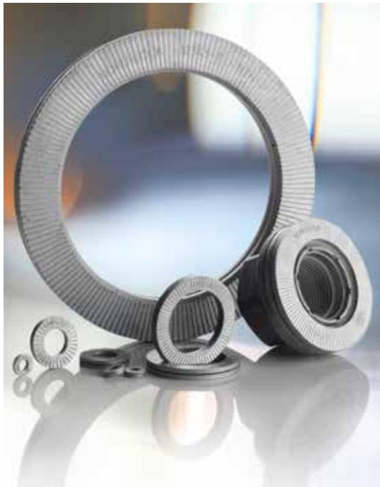
Шайбы Nord-Lock фиксируют болтовые соединения посредством натяжения, а не трения. Система состоит из двух шайб, имеющих клинья с одной стороны и радиально расположенные зубцы с другой стороны. Поскольку угол клина « $\alpha$ » больше, чем шаг резьбы « $\beta$ », создается «клиновой эффект», предотвращающий самоотвинчивание резьбового соединения.
