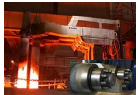
Электрододержатели дуговой печи. С помощью устройств MJT удалось добиться высокой силы зажима, чтобы выдерживать сильную вибрацию, действующую на рычаг электрода.
