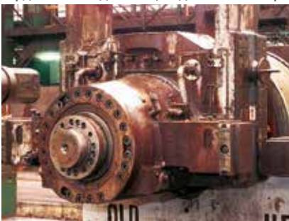
Упорные кольца на подушках для подшипника создают увеличенный предварительный натяг, по сравнению с предыдущим методом, и позволяют поглощать самые высокие пиковые нагрузки. Это увеличивает срок службы шеек прокатных валков и обеспечивает бесперебойную работу завода.
