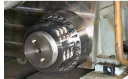
Упорно-разрезные гайки, специально разработанные в серии продукции Superbolt, значительно проще устанавливать и снимать по сравнению с большими резьбовыми крепежными деталями на крупных колоннах прессов.
