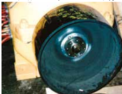
Гайки Superbolt двигателя привода фрезы представляют собой специальные стопорные гайки для крепления тормозных барабанов, муфт и шкивов к двигателям привода фрезы. Ими можно заменить гайки, поставляемые производителями двигателей.
